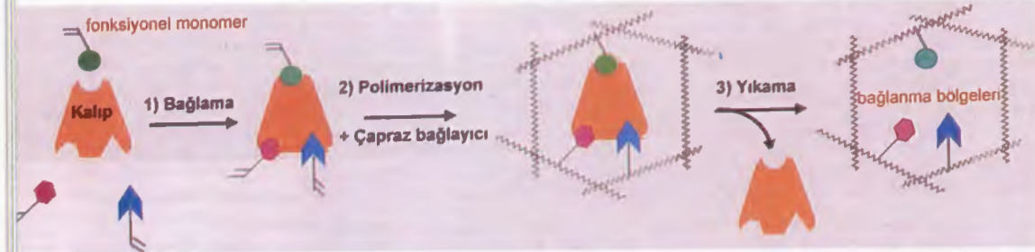
Şekil 7- Moleküler Baskılanmış Polimer Hazırlanmasının Şematik Gösterimi.
